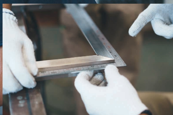
＜曲げ加工以降の組み上げる作業も徐々に教わっている。さしかなの扱いも手慣れてきた＞
