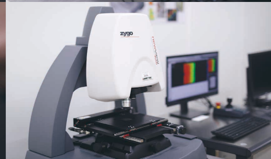
a: 3D光学プロファイラーに素材を設置しようとする菅原さん b: 得られたデータから状態を把握する c: 赤羽社長(中)と三田課長(右)に菅原さんがデータの内容を説明する d: 研磨された素材。検査はそれほど大きくないサイズのもので行う e: 3D光学プロファイラーは検査の強い味方だ
