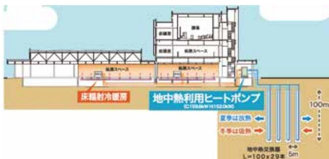
〈庁舎の地中熱ヒートポンプシステムのしくみ〉
