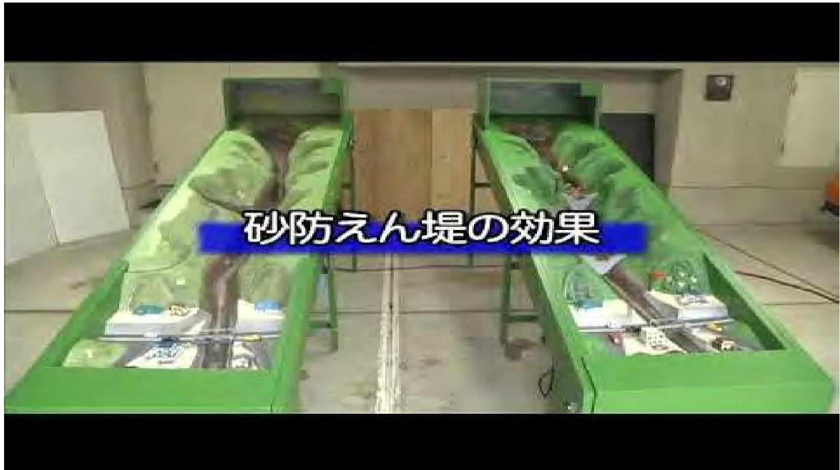
●砂防堰堤・土石流模型実験（Youtubeより）
