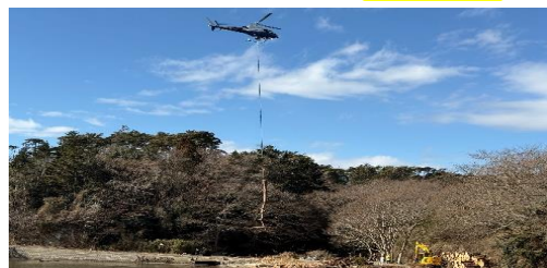
ヘリコプターによる被害材の搬出
