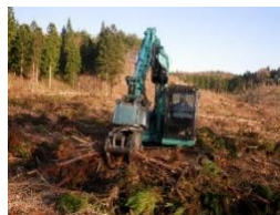
低コスト再造林の実践 (一貫作業での機械地 拵えの様子)
