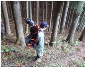
3Dレーザースキャナーによる森林調査
