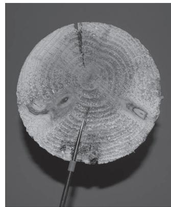
千枚通しでの腐朽判定
