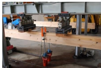
左：ツーバイフォー住宅への活用 右：スギ横架材（平角）の強度試験
