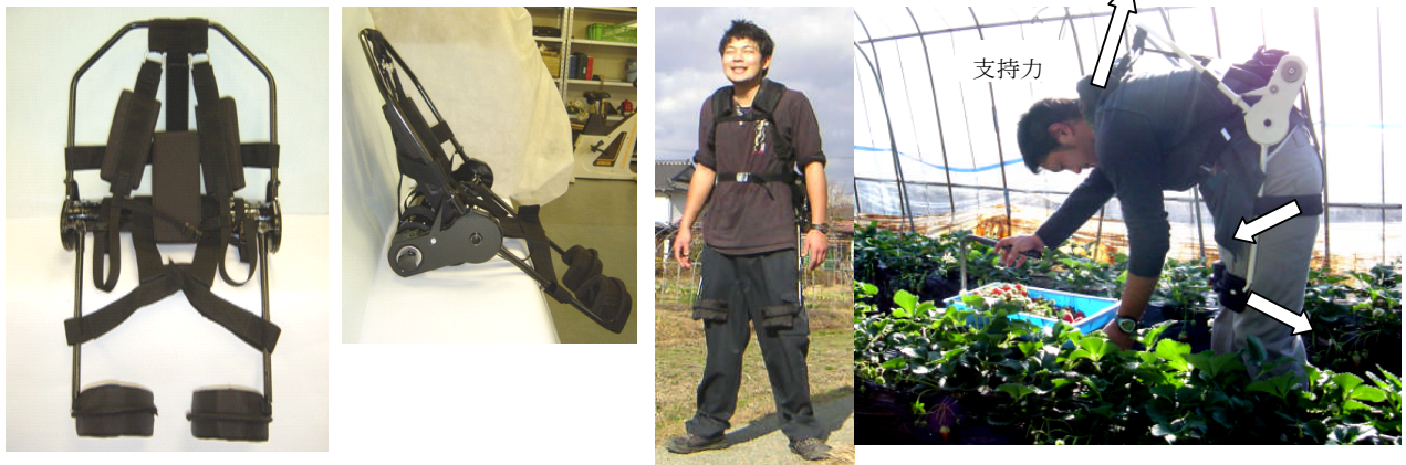
図1 中腰作業補助装置，装着時の正面及びイチゴ収穫作業時の使用状況
