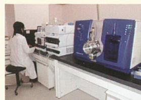
**液体クロマトグラフ tandem型質量分析計による測定**
