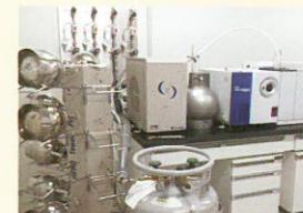
**ガスクロマトグラフ質量分析計による測定**
