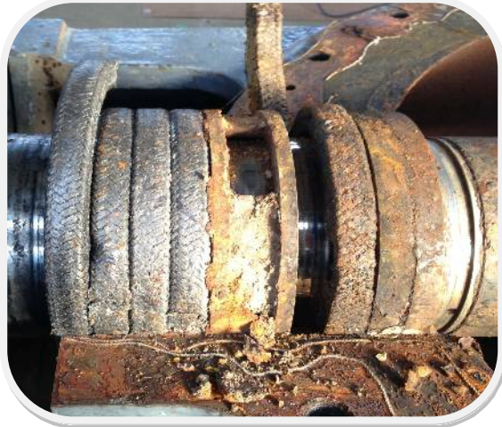
（写真1） 新しいパッキン（左側）は柔らかなままですが、古いパッキン（右側）はカチカチに硬くなっています。 （古いパッキンは12年前の整備時のパッキン）
