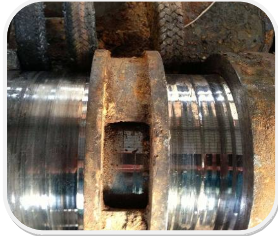
（写真2） 内側（右側）は堅いパッキンとの摩耗により、波打つように削られています。 外側（左側）のパッキンも交換しないで使用していたとすると、空気を吸い込み、真空を取ることができないことから落水の危険があったと考えられます。
