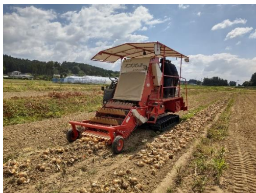
県事業で導入したピッカーによる収穫
