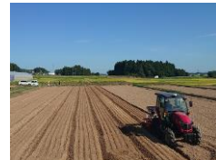
RTKシステムを活用したたまねぎの畝立同時播種
