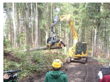
高性能林業機械を活用した立木の伐倒・玉切
