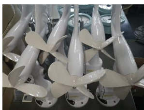
風車型の風向風速計
