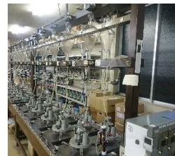
転倒ます型雨量計の調整
