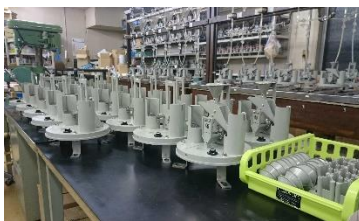
転倒ます型 ※ の雨量計組立て
