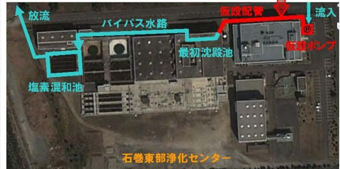
仮設沈殿池に流入した汚水は、大きなゴミや砂を沈殿させた後、塩素消毒をしてから旧北上川へ放流しました。なお、現在では、浸入水の削減と浄化センター汚水ポンプが稼動したことから、仮設沈殿池の運用は停止しました。
