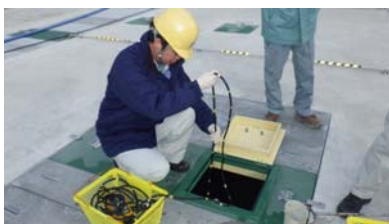
反応タンク内のMLSS濃度測定
