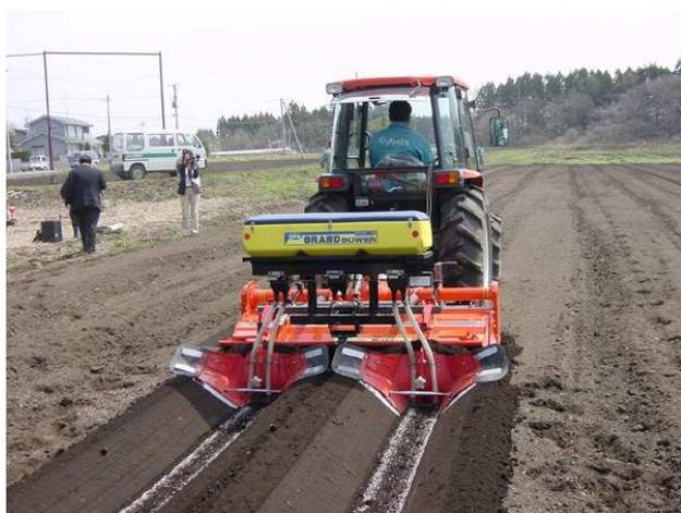
図4 ねぎのうね立て同時溝施肥作業
