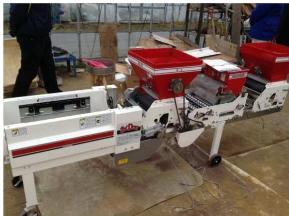
図6 みのるポット専用全自動播種機
