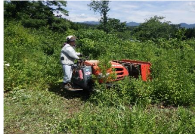
搭乗型下刈機稼働状況①
