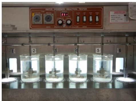
各ビーカーに異なる量のPACを注入して、攪拌、静置します。
