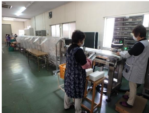
非破壊検査器による放射性物質濃度検査
