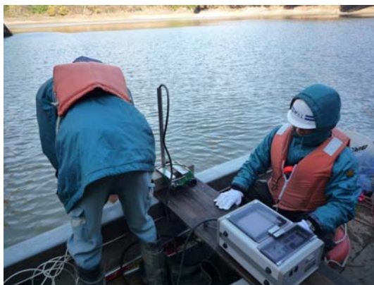
堆積土砂の観測(花山ダム)
