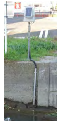
図:危機管理型水位計設置状況(大江川)
