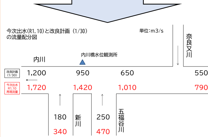
図：改良復旧事業における整備水準を変更した事例(内川)
