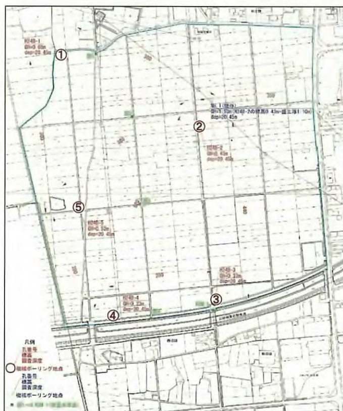
図 3.1-7 新蛇田地区ボーリング調査位置 (○)
