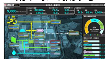
エネルギーマネジメントシステム
