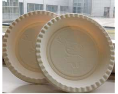
回収社会実験に使用している バイオマス複合プラスチック製皿
