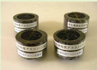
再生加熱アスファルト混合物
