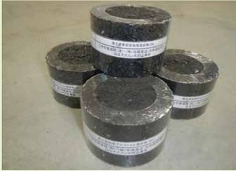
再生加熱アスファルト混合物
