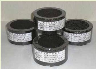
再生中温化アスファルト (フォームド) 混合物・再生加熱アスファルト混合物
