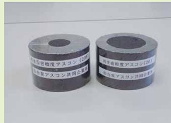
再生加熱アスファルト混合物
