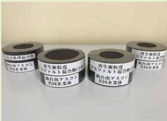
再生加熱アスファルト混合物
