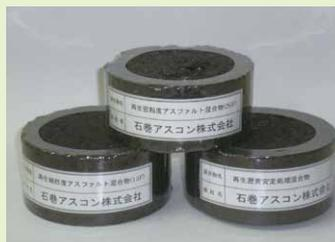
再生加熱アスファルト混合物
