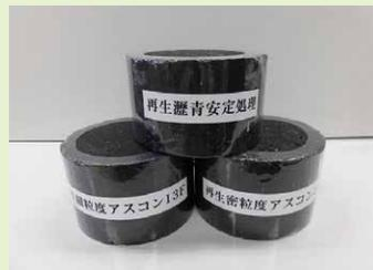
再生加熱アスファルト混合物
