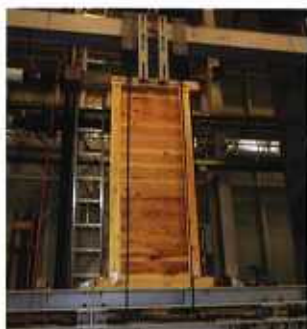
壁パネルの強度試験
