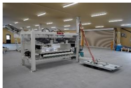
22 23 24 25 図 32：廃太陽光パネルの処理設備
