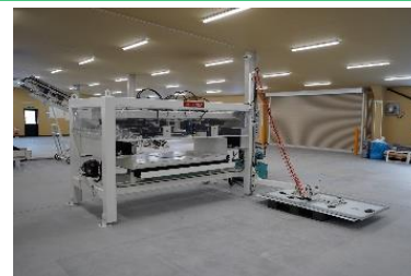
▲設備整備への助成 （廃太陽光パネルの処理設備）
