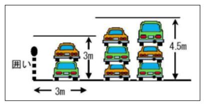
使用済自動車等を格納するための施設(保管する使用済自動車等の荷重に対して構造耐力上安全であるものに限る。)を利用して保管する場合 使用済自動車等の落下による危害が生ずるおそれのない 高さ
