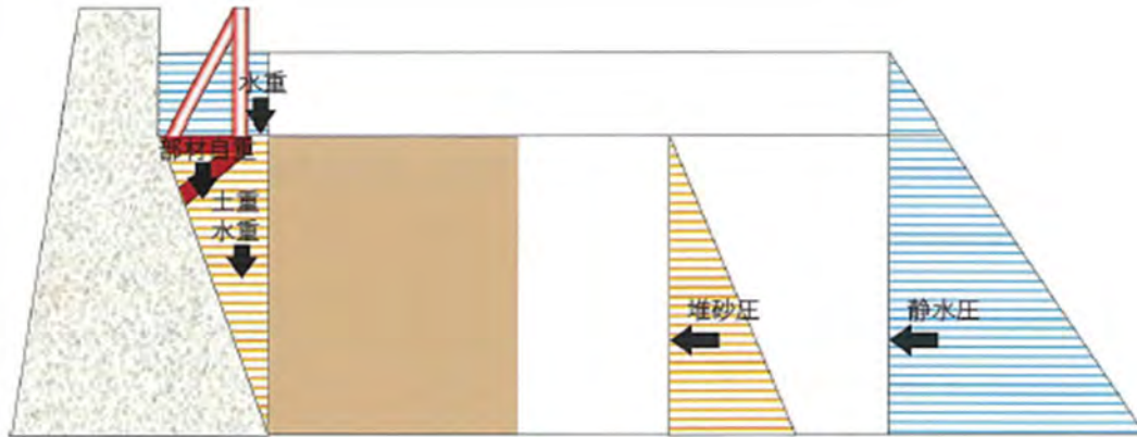
図 10-3-15 直付けする場合の設計外力（満砂）
