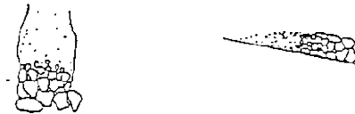
図 1-5-5 土石流による堆積状況
