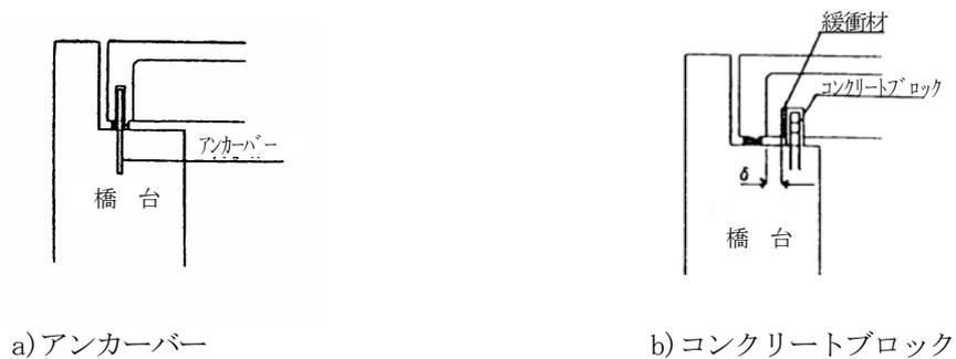
図2-33 P C 橋の変位制限構造例
