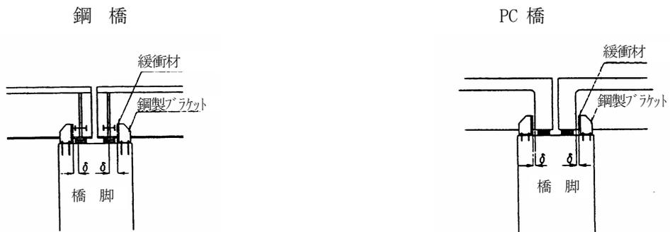
d) 鋼製ブラケットを用いる落橋防止構造
