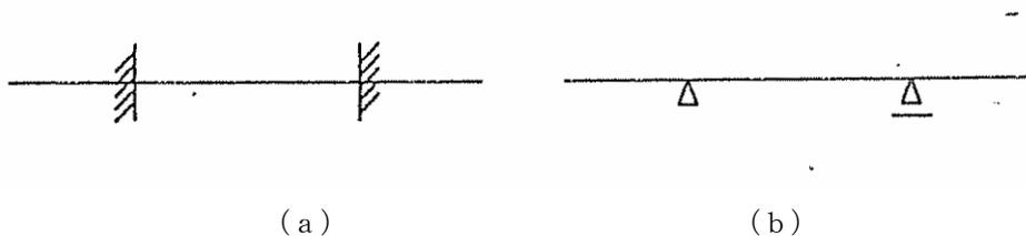
図 4-90 床版の死荷重による曲げモーメントを算出するための解析モデル
