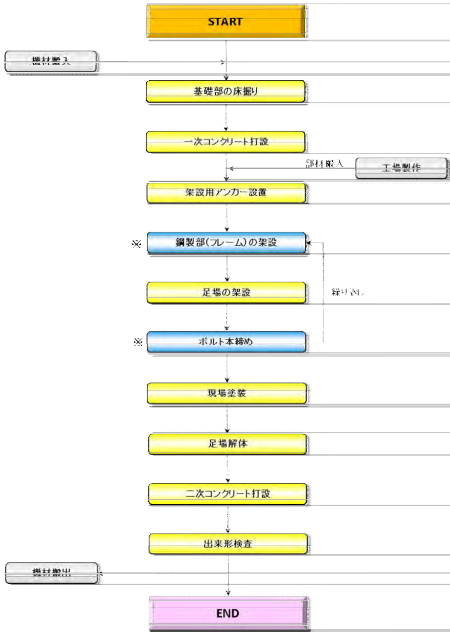
図- 18 施工フロー
