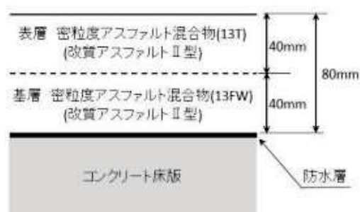
図 2-52 橋面舗装の舗装構成
