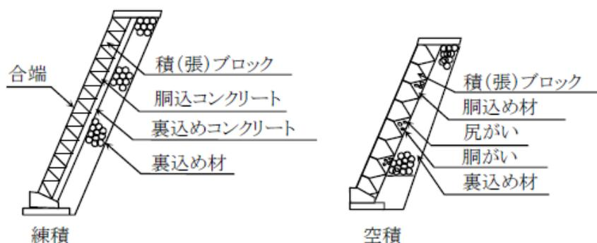
図2-5 コンクリートブロック工
