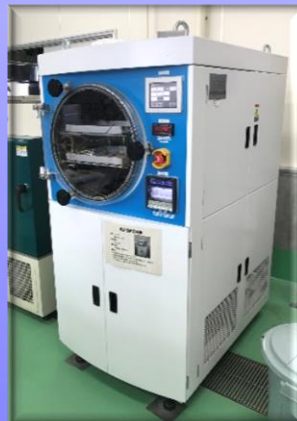
真空凍結乾燥機 (ULVAC DFR-5N-B)
