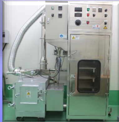
電子スモーク装置 (北陽 USM-1AF-PH)
