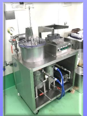
真空フライヤー (アトラステクノサービス)
