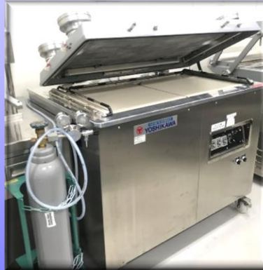
多用型真空包装机 (吉川工業 LHG-P60)
