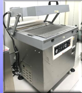
密着真空包装机 (吉川工業 HI-750)
