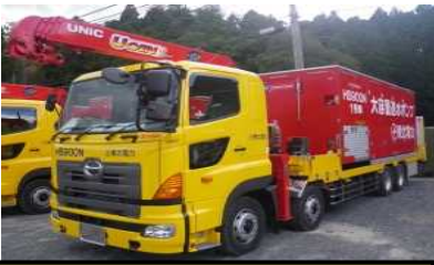
大容量送水ポンプ(タイプI)
