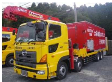
大容量送水ポンプ(タイプ I)
