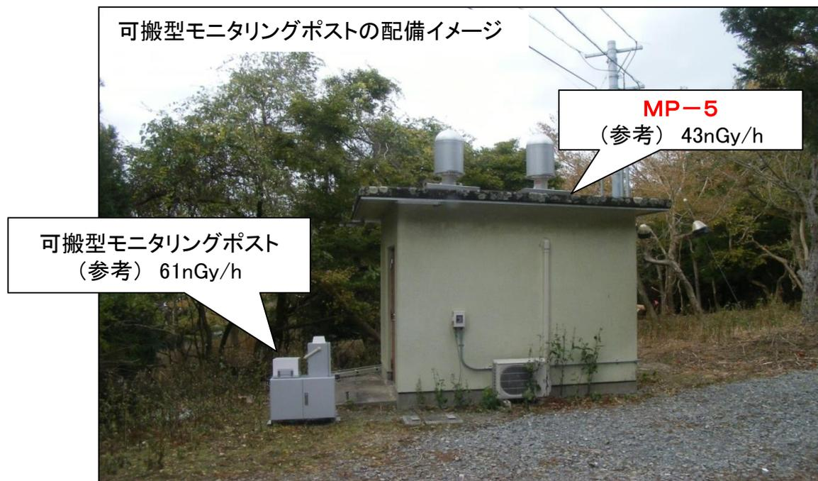
(参考): MP-5移設検討時に実施した並行測定結果
