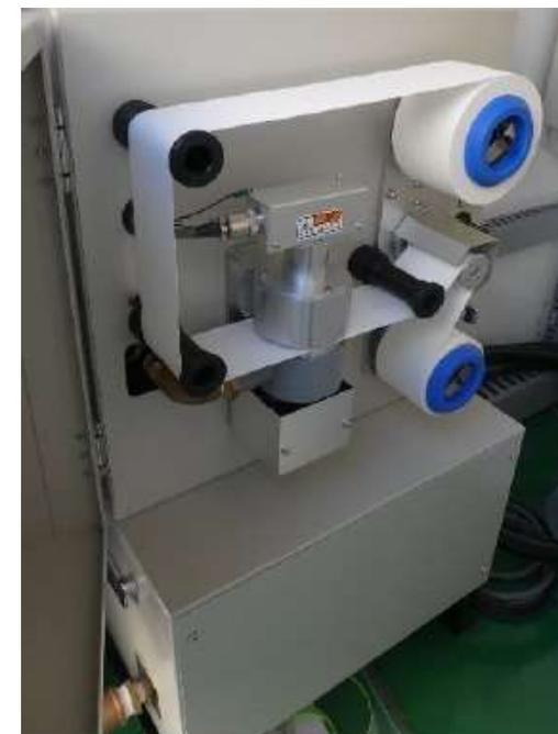
図 3-1 ダストモニタの機器構成例
