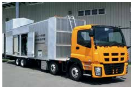
ガスタービン発電機
