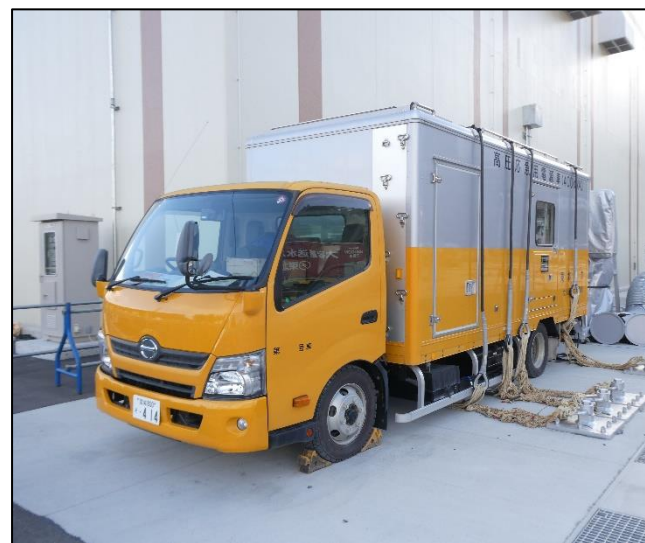
電源車の外観
