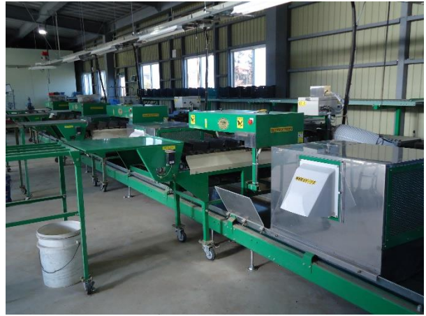
長ねぎ出荷調整施設
