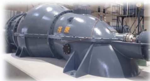
▲新設機場モーターポンプ
