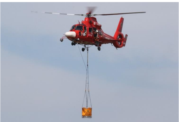
空中消火装置 (消火バケツ)
