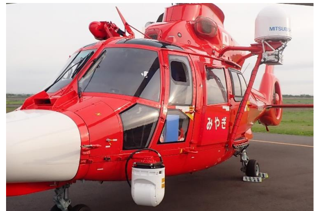
ヘリコプター衛星通信システム (ヘリサット)
