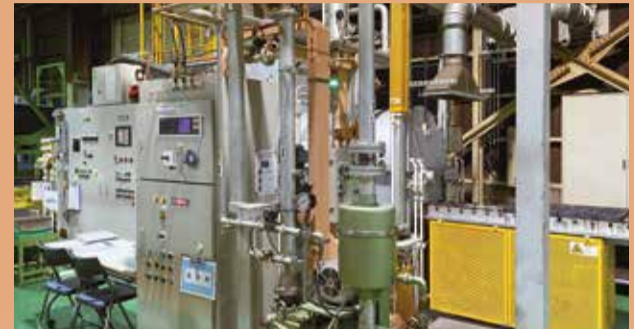
バッチ式熱処理炉⇒繊細な条件設定が可能
