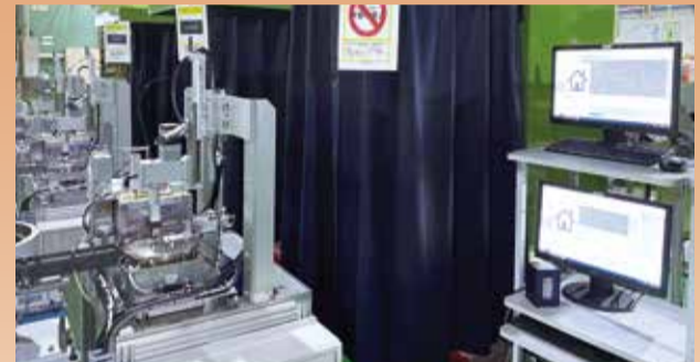
自動磁粉探傷検査ライン⇒破壊起点となり得る割れをチェック
