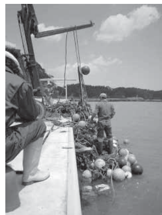
(船へ装備したがれき回収装置)
