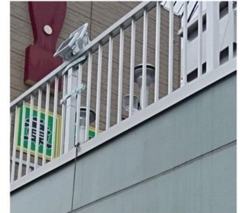
PM2.5センサーと測定局設置の図
