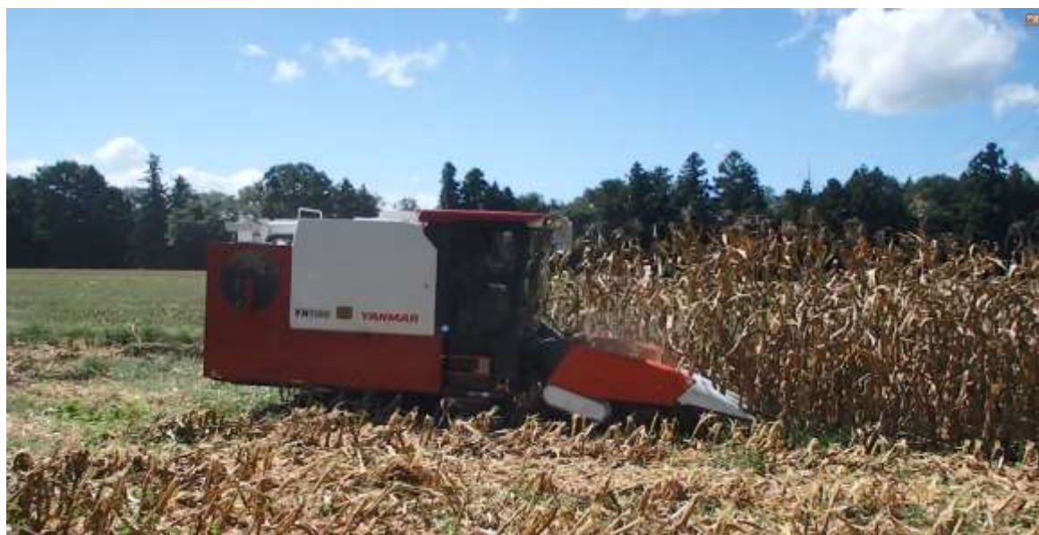
図1 コーンヘッド装着の汎用コンバイン収穫作業
